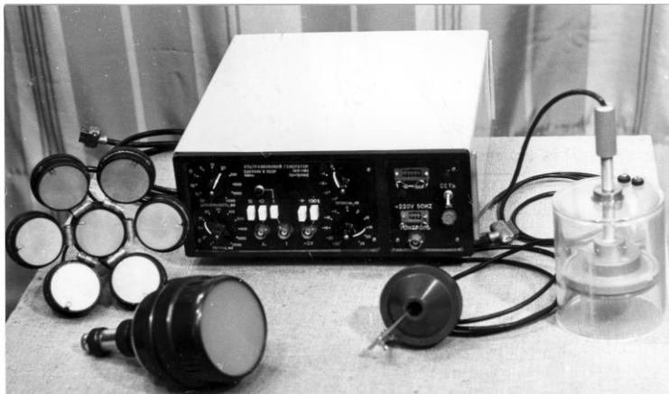
Рис. 12. Генератор УЗГМ-250 (характеристики см. в тексте), разработанный с комплектом фокусирующих преобразователей.
