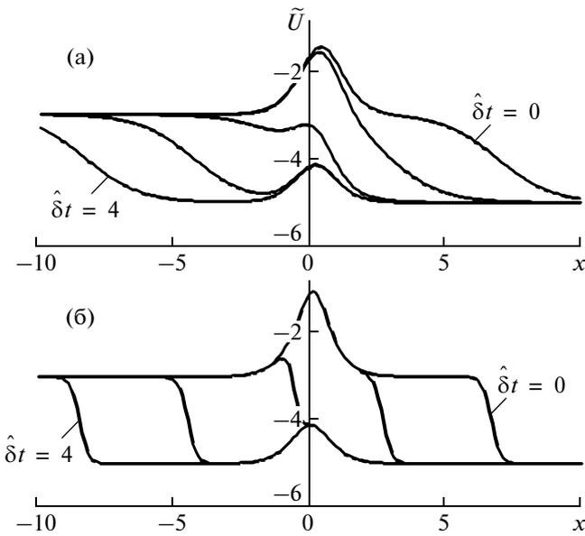
**Рис. 4.** Прохождение ступенчатого возмущения через область неоднородности при различной вязкости среды, рассчитанное на основе уравнения (26). Показаны профили волн  $\tilde{u} = u_n / (2\hat{\delta})$  в последовательные моменты времени  $\hat{d}t = 0, 1, 2, 3, 4$ . (а) Решение, полученное с применением 1-кратного преобразования Дарбу. (б) Решение, полученное 8-кратным преобразованием Дарбу; при этом коэффициент вязкости в 6 раз меньше, чем в предыдущем случае.
