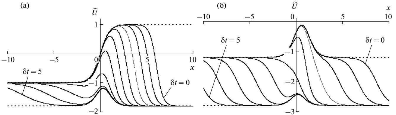
**Рис. 3.** Прохождение ступенчатого возмущения через область неоднородности (перестройка потока в сопле Лавалья). Показаны профили волны в последовательные моменты времени. (а) Случай перестройки трансзвукового потока в дозвуковой:  $\alpha = -1.4$ ,  $\Delta\alpha = 0.4$ ,  $x_0 = 20$ ,  $\delta t = 0, 1, \dots, 10$ . (б) Случай перестройки одного дозвукового режима в другой:  $\alpha = -2$ ,  $\Delta\alpha = 0.8$ ,  $x_0 = 10$ ,  $\delta t = 0, 0.5, 1, \dots, 5$ .
